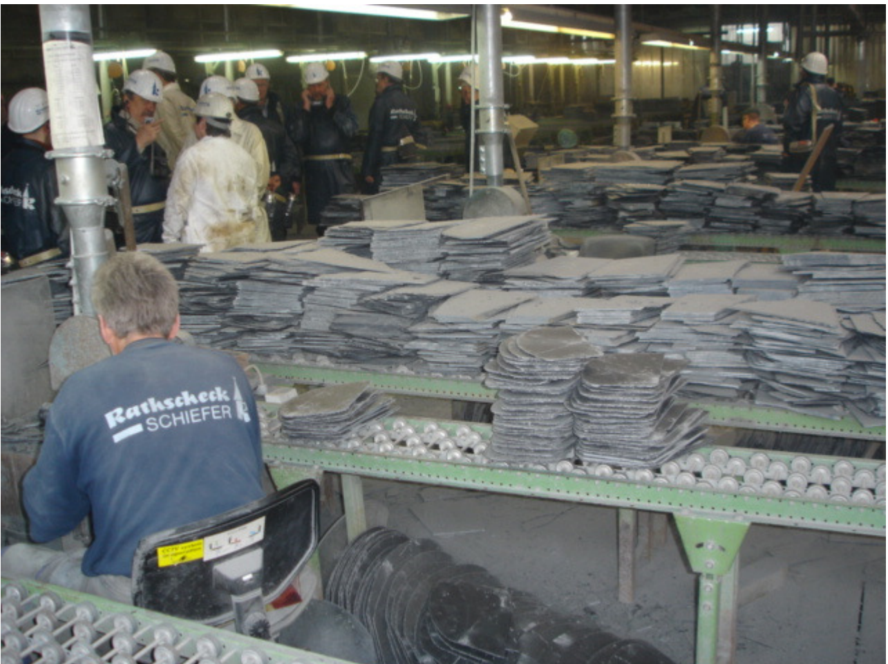
der Meister der Hiebformen von Schiefer-Decksteinen im Vordergrund (die Fachlehrer beim Zuschauen der Künste des Schieferbearbeitens im Hintergrund)
